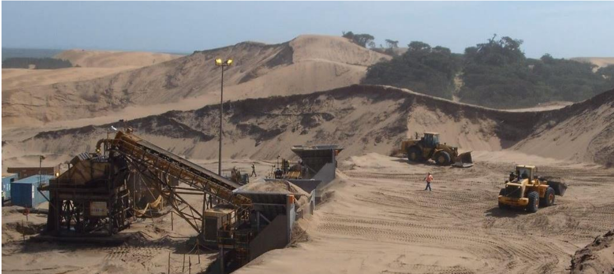
Figure 4 : "Dry Mining Unit" dans une mine en Afrique du Sud (Les unités situées à gauche sur la photo sont montées sur patins et mobiles)
