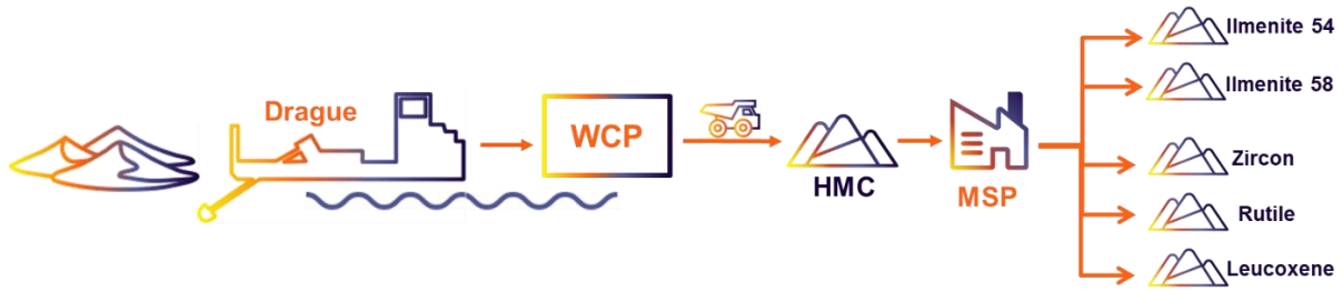
Figure 1 : Représentation schématique du procédé actuel de GCO
