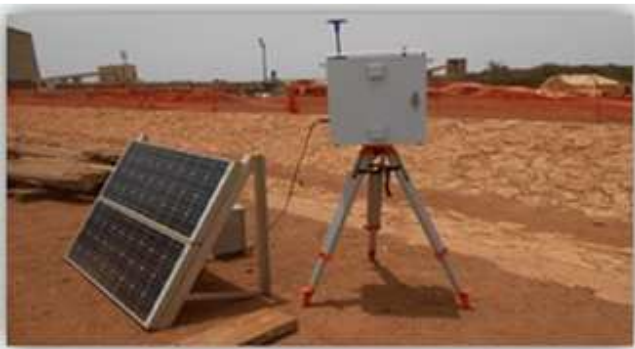
Figure 20. Déploiement du Dusttrack pour le suivi de la qualité de l'air
