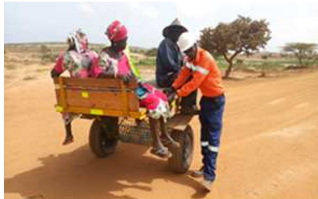
Figure 56. Pose de bandes réfléchissantes sur une charette
