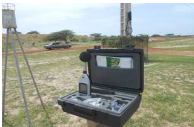
Figure 25. Déploiement du sonomètre pour la mesure des émissions sonores
