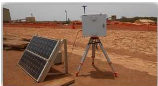
Figure 15. Déploiement du Dusttrack pour le suivi de la qualité de l'air
