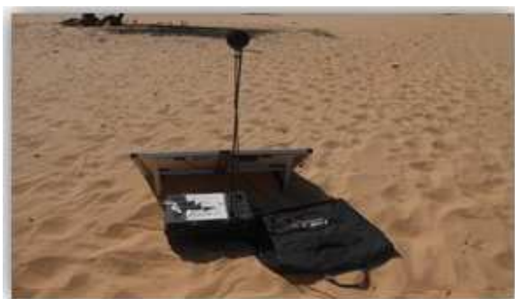
Figure 20. Déploiement du sonomètre pour la mesure des émissions sonores
