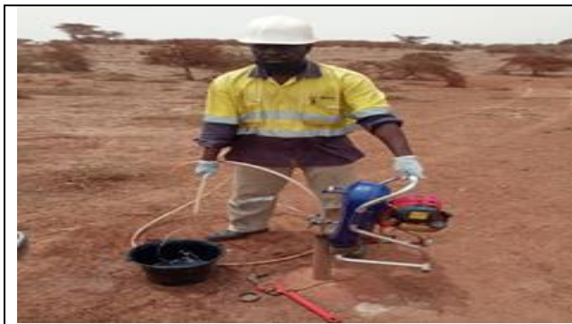
Figure 9. Prélèvement d'échantillon d'eau à partir d'un piézomètre (eau souterraine)
