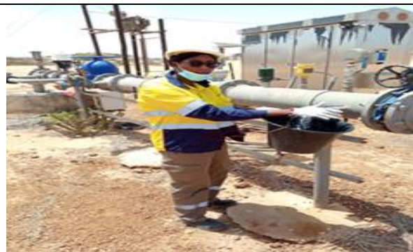
Figure 10. Prélèvement d'échantillon d'eau à partir d'un forage profond (eau souterraine)
