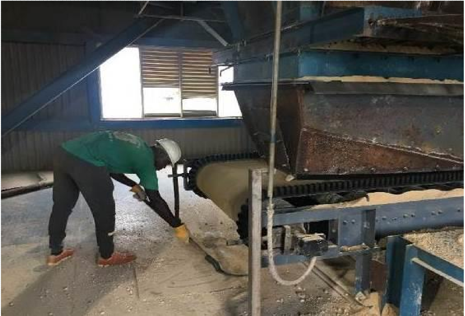
Techniciens de surface sans EPI complets (absence de port de chaussures de sécurité, de masques à poussières, etc.)
