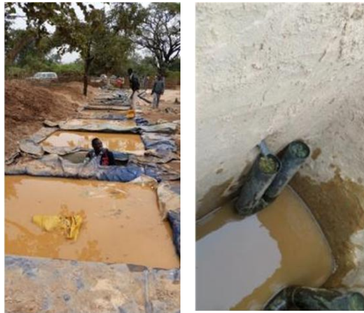
Photo 4.3.4 Dispositif de traitement au cyanure à Guémedji
