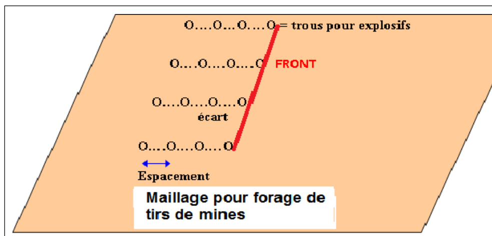
Figure 1: Schéma du mode opératoire des tirs de mines
