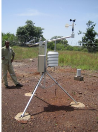
Plaque 3 : station météorologique automatique.
